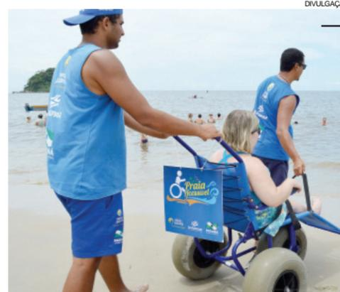
As cadeiras têm rodas especiais e capacidade para até 120 quilos, são flutuantes e confeccionadas em material leve, resistente e inoxidável, o que permite ao usuário entrar na água a uma profundidade segura
