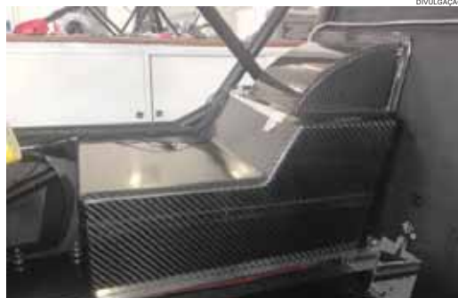
Novo tanque de combustível, em fibra de carbono, é mais seguro para o piloto
