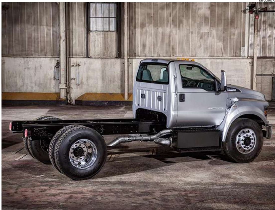
Os novos F-650/F-750 oferecem três versões de cabine (regular, supercab e dupla) e de chassi (reto, para dock de carga e reboque pesado)
