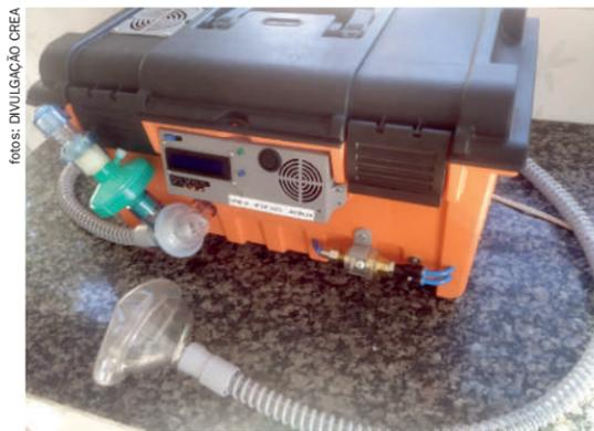
automática. O protótipo possui dispositivos, acessórios, fontes, sistemas de controle e sensores, sistema de refrigeração, e fica dentro de uma caixa para que seja seguro e fácil de transportar”.
