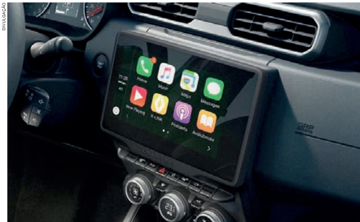
Sistema permite a conectividade sem fio de smartphones por meio do Android Auto e Apple CarPlay
