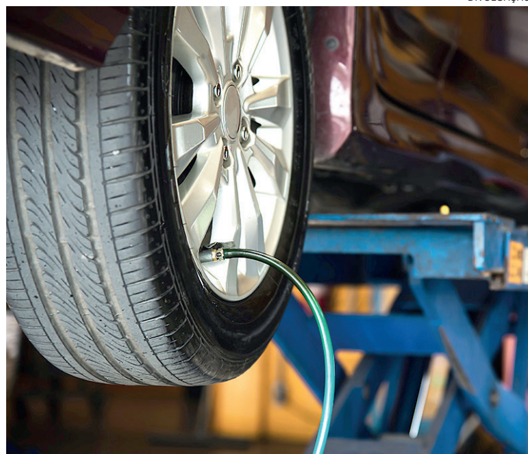
A calibragem correta e com o uso de nitrogênio, aumenta vida útil dos pneus e previne acidentes
