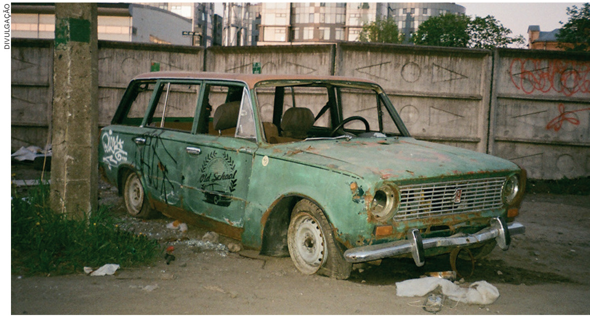
Carro parado por muito tempo sofre com corrosão, oxidação e ferrugem ao longo da inatividade, tanto na lataria como na estrutura interna (motor, bateria, freios...)
