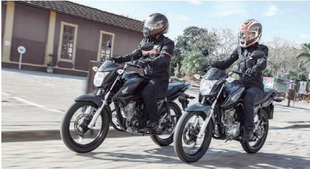
Na parte ciclística, as Honda CG se valem do robusto chassi tipo Diamond de aço estampado, com suspensão dianteira telescópica e traseira com dois amortecedores. A diferenciação entre as versões da CG no quesito ciclística ocorre no sistema de freios: CG 160 Titan, CG 160 Fan e CG 160 Cargo tem disco na dianteira e tambor na traseira e rodas de liga leve, enquanto
