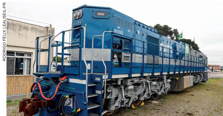
tados, podendo ser monitorados remotamente, permitindo antever possíveis falhas. Já as baterias são acionadas automaticamente pelo sistema da locomotiva, alinhada à potência exigida pelo maquinista para o trecho em que irá circular.
