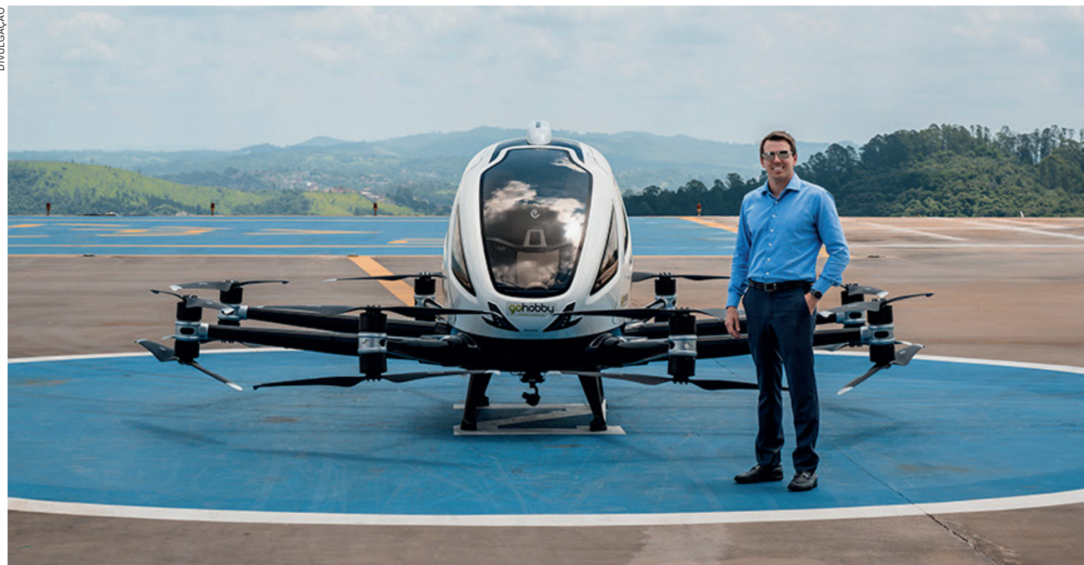
O eVTOL 216-S transporta até duas pessoas e bagagem de mão, com uma carga útil total de 220 kg em um alcance de 30 km.
