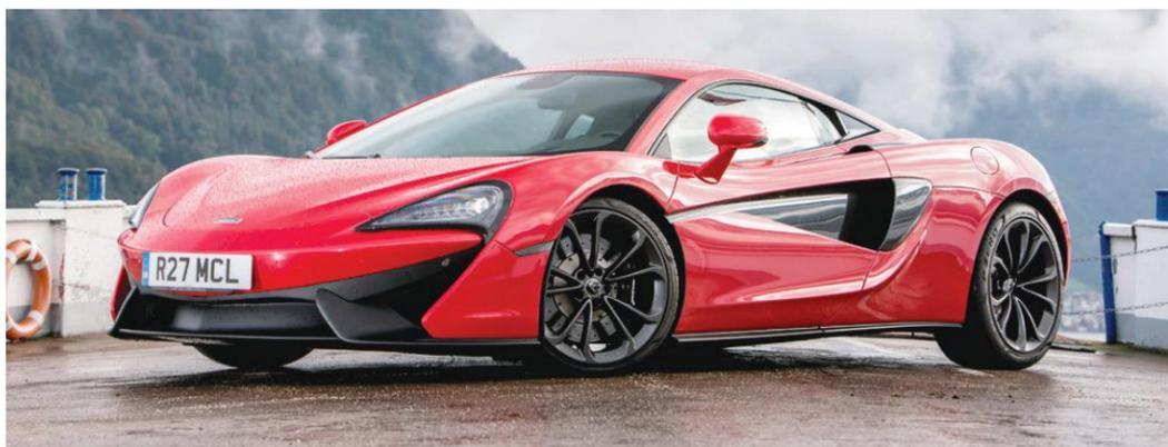
ra da cabine, o que otimiza o fluxo sobre a cobertura traseira para aumentar os níveis de carga aerodinâmica e ajudar no resfriamento do motor. Um spoiler integrado na borda traseira traseiro proporciona o downforce ideal.
