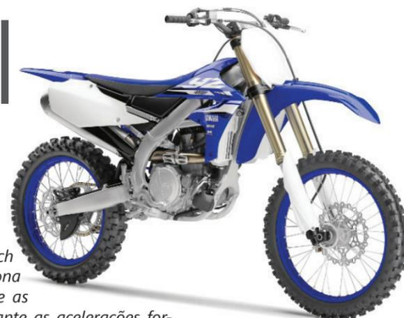
A YZ450F 2018 leva a conveniência da partida elétrica através de um botão para a pista de competição
