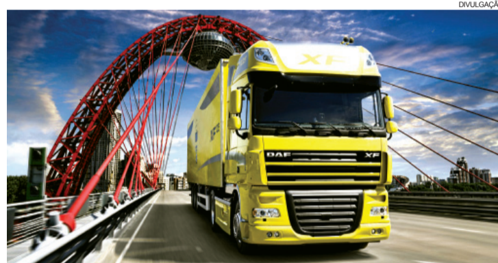
O XF105 é um extrapesado com capacidade máxima de carga de 74 toneladas e é indicado para o transporte pesado de longas distâncias
