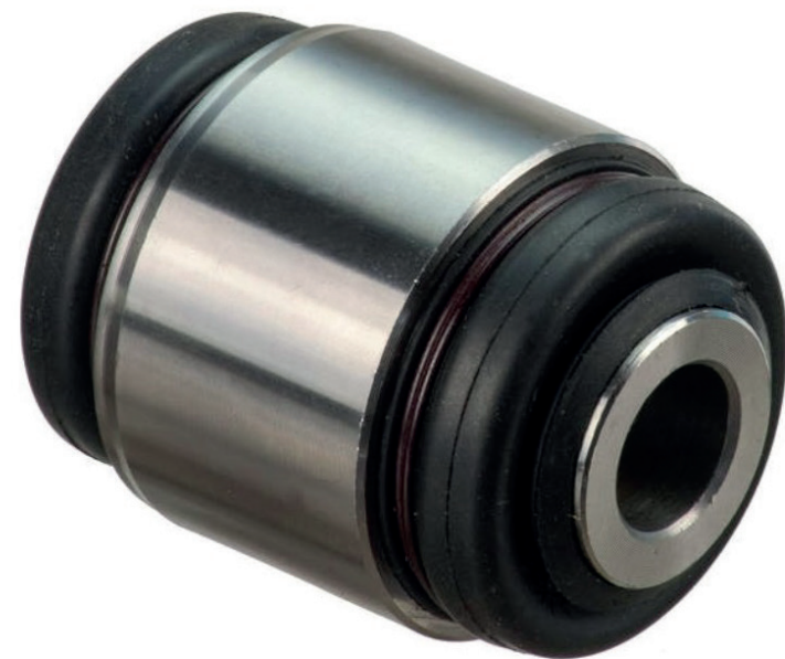
A bucha conecta diferentes peças da suspensão e seu desgaste pode levar a danos nos demais componentes e comprometer o conforto e a segurança ao dirigir
