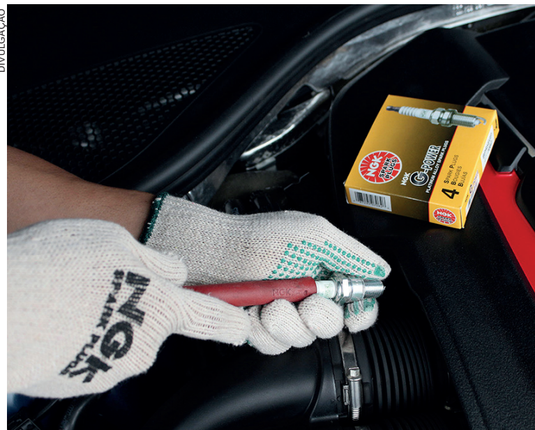
Acúmulo de resíduos merece atenção e as velas devem ser substituídas regularmente
