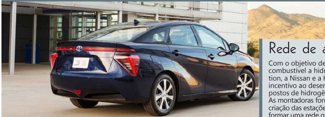
O Toyota Mirai movido a hidrogênio percorre 502 km liberando apenas vapor d'água na atmosfera
