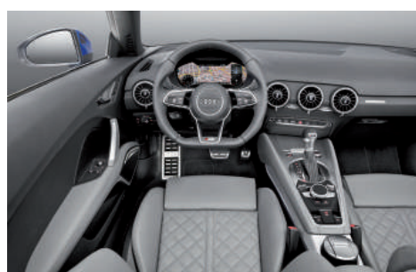
O cockpit virtual da Audi fornece todas as informações dentro do campo de visão do motorista
