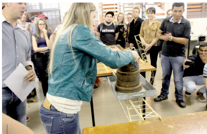
Pesos foram colocados para mensurar quanto a ponte suportaria
