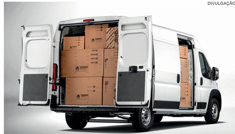
com motor com novo motor 2.2 Turbo Diesel que entrega 140 cv e 350 Nm de torque, combinado ao câmbio manual de 6 marchas. Com consumo urbano, de 10,8 km/l. O volume de carga chega a 13 m<sup>3</sup>, com capacidade entre 1.240 e 1.590 kg, a depender da versão, com abertura traseira de 270° e porta lateral deslizante que facilita o dia a dia no transporte.
