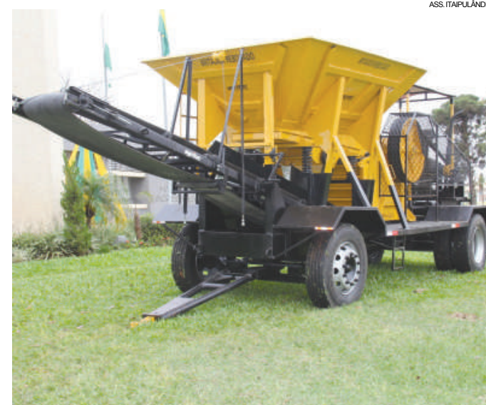
Britador móvel auxiliará na eliminação de pedras às margens da rodovia
