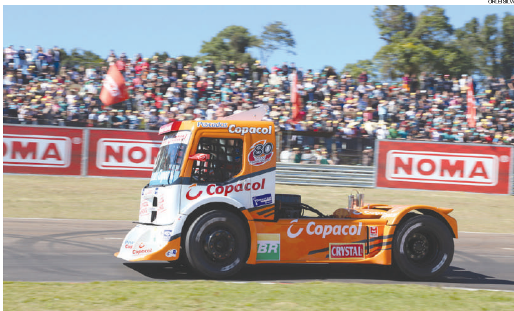
Diogo Pachenki abandonou a prova com superaquecimento do motor de seu Volvo
