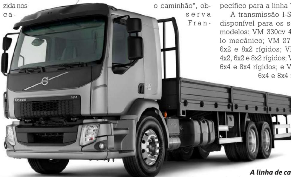
A linha de caminhões VM vem equipada com a caixa de câmbio eletrônica I-Shift, a mesma que equipa o caminhão extra-pesoado da Volvo
