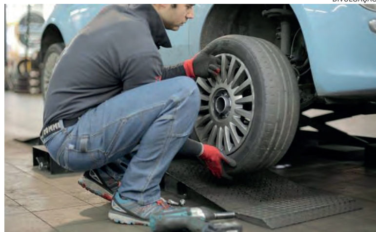
Antes de pegar a estrada, é recomendado verificar o desgaste dos pneus, calibragem e se há bolhas ou cortes. Pneus em mau estado são causa comum de acidentes
